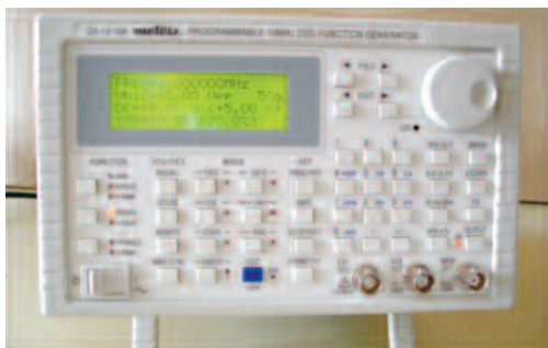
Metrix GX1010-A Signal Programmable de 0,1 Hz à 10 MHz
